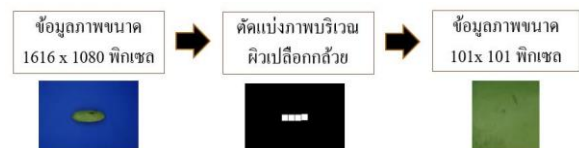
ภาพที่ 1 ขั้นตอนการตัดแบ่งภาพบริเวณผิวเปลือกกล้วยให้เป็นภาพขนาดเล็ก 101 \times 101 พิกเซล
